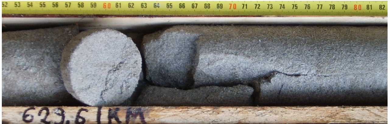
Zdj.72. Dwa spękania strome na gł.629,63m
