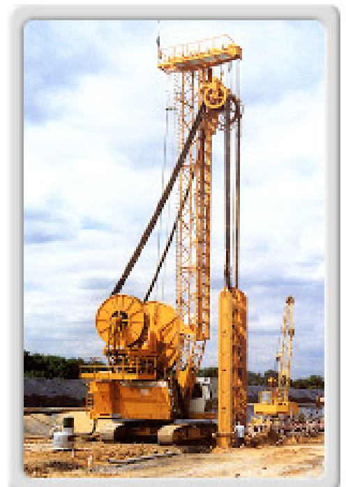
Rysunek 1 zestaw do wykonania ścian szczelinowych
