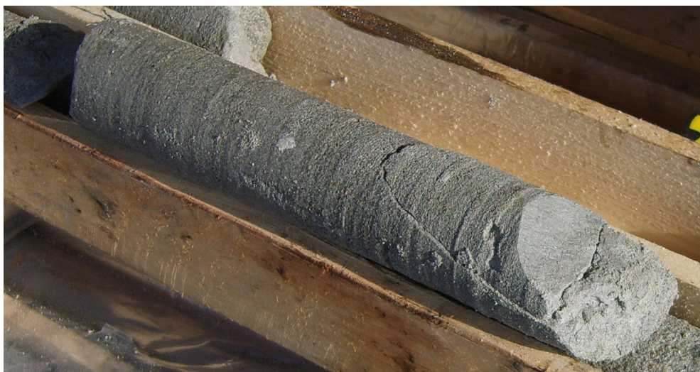
Zdj.70. Spękanie o charakterze łuski (o kącie 76^\circ i dł.25cm) w piaskowcu drobnoziarnistym na powierzchni, którego widoczne są rysy ślizgowe.
