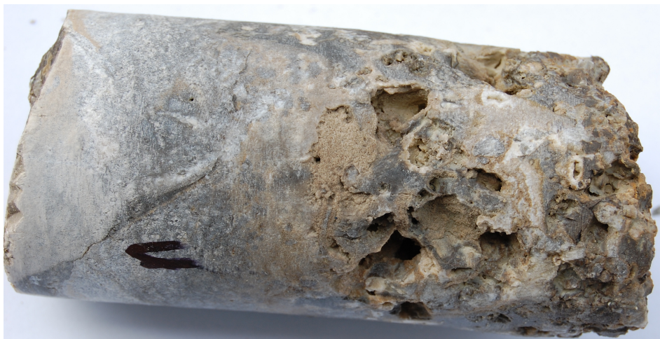
Zdj.9. Fragment wapienia silnie skawernowanego (151,62-151,78m).
