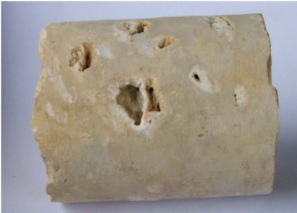
Zdj.7. Kawerny wypełnione kalcytem (150,93-151,00m).
