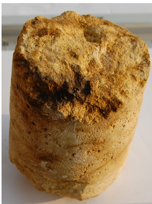
Zdj.4. Fragment wapienia biało-żółtego z pojedynczymi niewielkimi kawernami i szczelinami wypełnionymi brunatną substancją żelazistą 994,62-94,70m).
