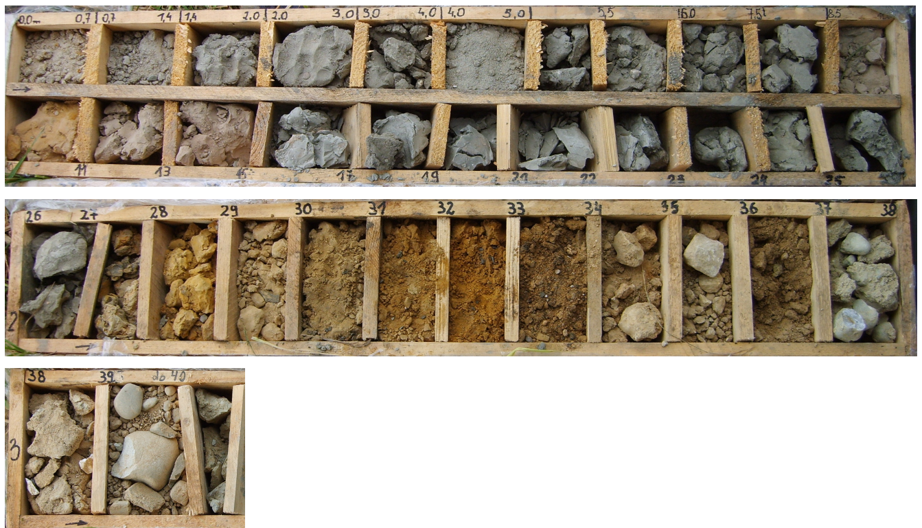
Zdj.1. Profil czwartorzędu (0,00-40,50m).
