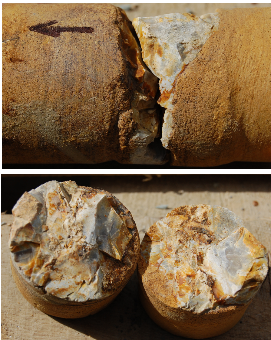
Zdj.6. Soczewka substancji krzemionkowej (gł.141,00m).
